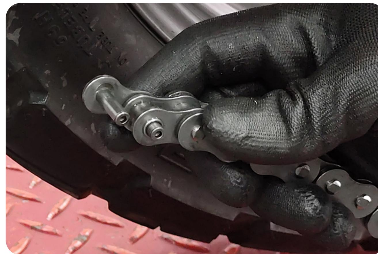
PRENDA UMA PONTA DA NOVA CORRENTE NA USADA E GIRE A RODA TRASEIRA, GUIANDO A CORRENTE COM A MÃO ATÉ QUE A NOVA PASSE COMPLETAMENTE.
