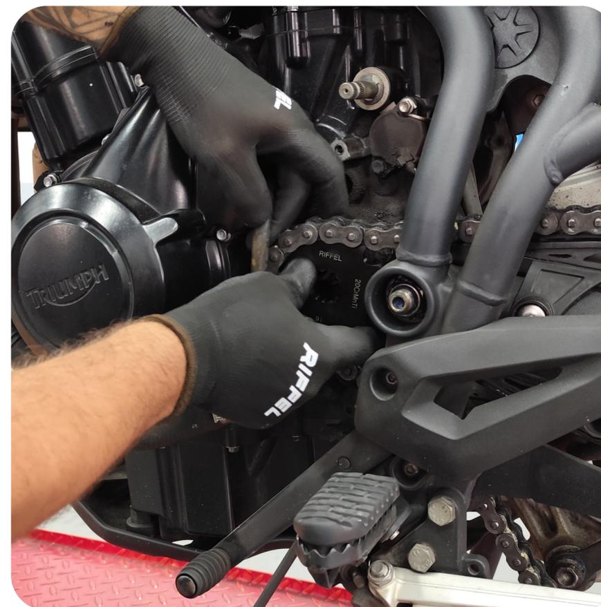
IDENTIFIQUE O ELO DA CORRENTE USADA QUE SERÁ CORTADO PARA REMOVÊ-LA (NÃO REMOVA A CORRENTE USADA IMEDIATAMENTE DA MOTO, POIS ELA AJUDARÁ A GUIAR A COLOCAÇÃO DA NOVA CORRENTE).
